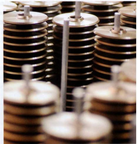
Bild oben: Textilmesser auf dem Weg zur automatischen Laserbeschriftung.
