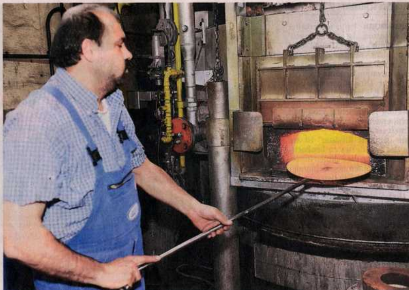
Veli Irul, Mitarbeiter in der Härterei, nimmt ein Rundmesser aus dem Ofen. Das Metall wird bei Temperaturen zwischen 900 und 1200 Grad gehärtet.
